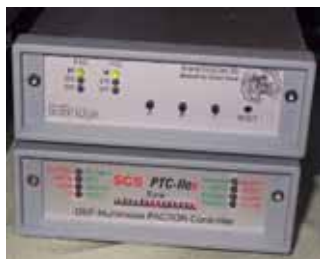
Das neue Interface von Hinztec ermöglicht es, handelsübliche Faxgeräte in Pactor-Kurzwellenverbindungen einzusetzen.
