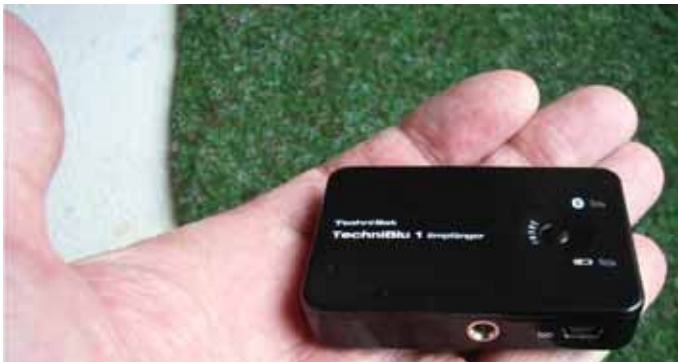
Klein und stark: TechniBlu 1 – hier der Empfänger, an den z. B. ein Ohrhörer angeschlossen werden kann. Fotos: Hurcks
