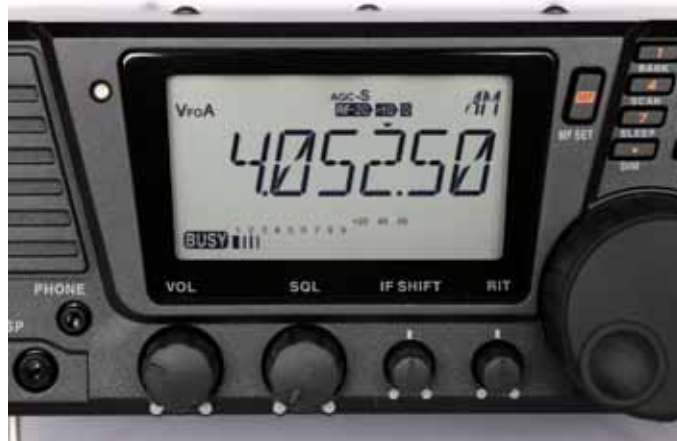
Bedienfeld des DX-R8. Unter dem kontrastreichen LC-Display liegt u.a. der Drehknopf für IF Shift (Passband Tuning).
