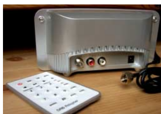
DR-500: Robuster F-Buchse für die Antenne und gut ablesbare Fernbedienung.
