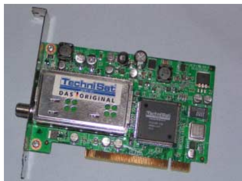
Bild links: Zum Datenempfang eignen sich nicht alle Sat-Karten, mit der hier abgebildeten SkyStar2 ist es möglich. Bild rechts: Sendefähige Sat-Antenne, erkennbar an der Sendeeinheit (mit Kühlrippen) im Spiegelfokus. Fotos: Dieter Görrisch
