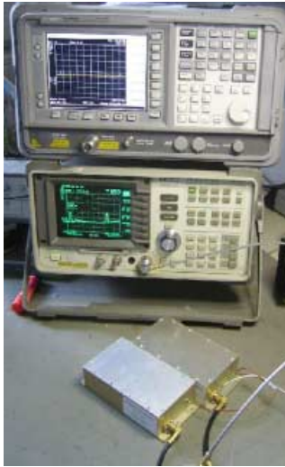
Bild rechts: Die DAB-Stationsantenne aus Bad Blankenburg während der Messplatzüberprüfung am Netzwerkanalyzer HP 8753B.
