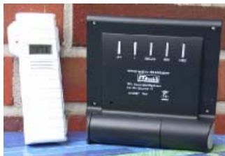
Der externe Temperaturfühler (li.). Auf der Rückseite der Wetterstation befinden sich fünf Funktionstasten.
