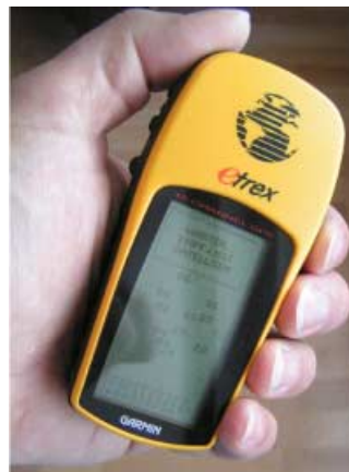
Outdoor-Navigationsgeräte wie das Etrex von Garmin arbeiten nicht mit Strassenlisten, sondern mit frei speicherbaren Geländepunkten (Wegepunkten).
