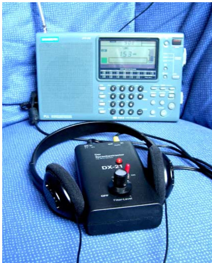
Das Gegenmittel bei Störungen auf Kurz-, Mittel- oder Langwelle: der Sprachextractor. Hier betrieben am Sangean ATS-909 und mit Kopfhörer. Wirksam bei analogem Empfang aller Art. Foto: Dieter Hurcks
