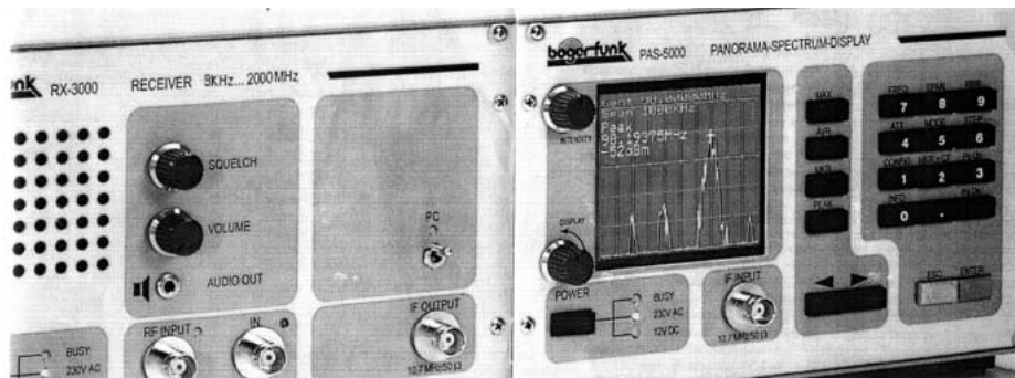
Der EMI Testreceiver von Bogerfunk ermöglicht preisgünstige EMV-Messungen.
