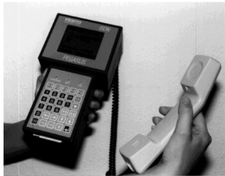
ISDN-Prüfapparat der Firma Festo mit Mithöreinrichtung. Foto: Festo
