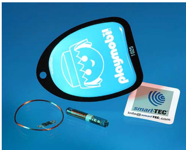
Ein Beispiel für die kontaktlose Datenübertragung ist der Hybrid-Schlüsselanhänger von smart-TEC, z. B. für die Zutrittskontrolle und Zeiterfassung.
