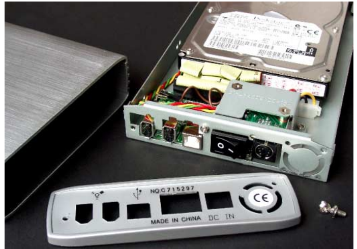
Der Einbau der Festplatte in das Gehäuse sollte auch einen handwerklich weniger Begabten kaum vor Probleme stellen. Fotos: urc
