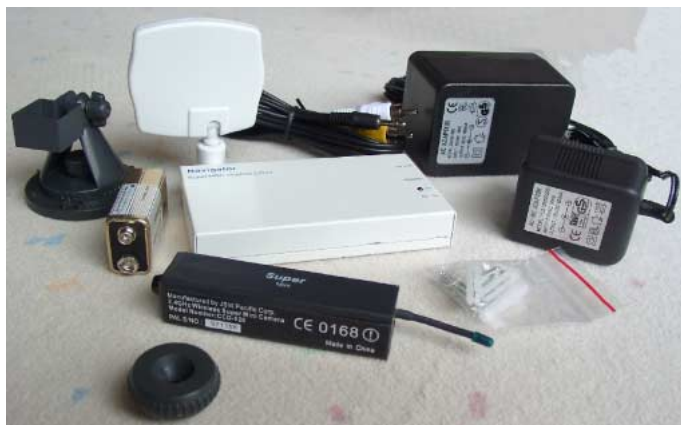
Der Lieferumfang (Batterie nur zur Darstellung des Größenverhältnisses im Bild): Netzteile, Kamera mit Stummelantenne, Empfänger mit Flachantenne und Zubehör. Fotos: urc
