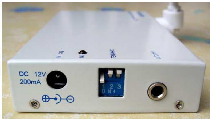
Anschluss für das Netzteil (links), DIP-Schalter für die Kanalwahl und Kombibuchse (Klinke 3,5 mm) für Audio/Video (rechts).
