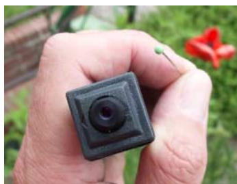
Stecknadelkopfgröße: das winzige Objektiv der Minikamera.
