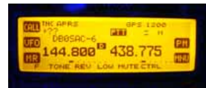
Mit dem „TinyTrack“-Modul (unten) wird jedes gewöhnliche Funkgerät zur APRS-Datenschleuder. Oben: APRS-taugliche Mobilfunkgeräte wie das TMD700 von Kenwood zeigen die dekodierten Daten direkt im Display an.
